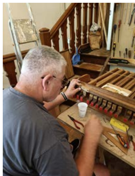
Câblage pour transmission électrique
