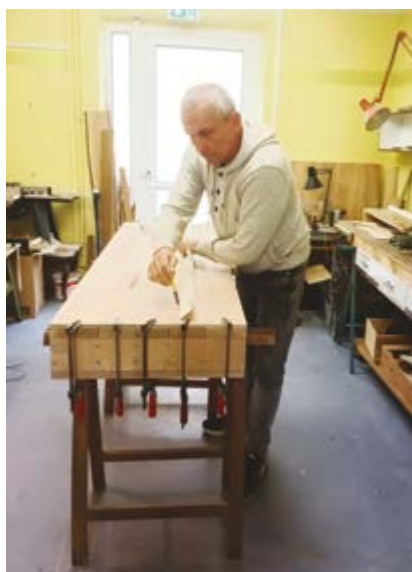
Fabrication d'un sommier
