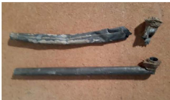
**Traction mécanique :** Toutes les vergettes seront vérifiées une à une. Les crochets et filetages cassés seront remplacés. Il y en a des centaines.
